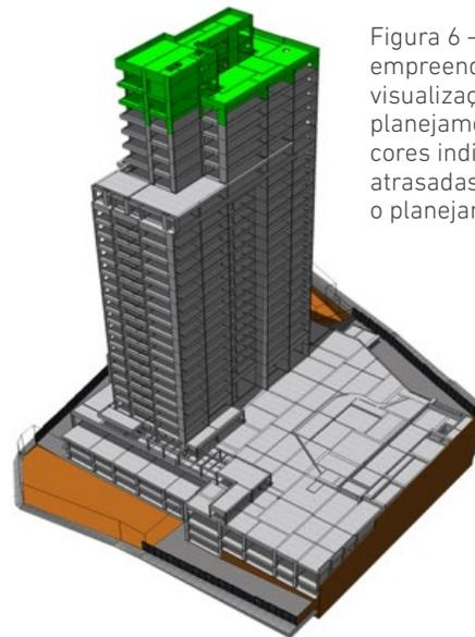
Figura 6 – Exemplo de modelo BIM de empreendimento da Tarjab, onde, além da visualização 3D, é possível acompanhar o planejamento (4D), onde as diferentes cores indicam etapas adiantadas (verdes), atrasadas (laranjas), ou de acordo com o planejamento (cinza)
