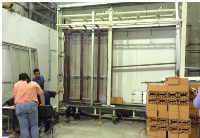
**Figura 4** - Ensaio de desempenho da fachada ventilada em placas cerâmicas: ensaio de resistência à carga de vento e drenabilidade a água (foto do autor)
