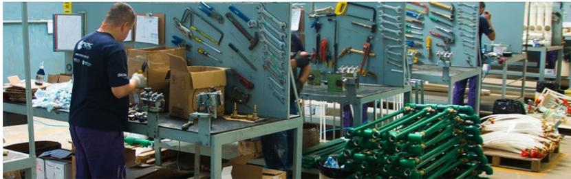
**Figura 10** – Exemplo de ambiente fabril, com ferramentas e controles adequados e conceitos de linha de produção para pré-fabricação de componentes da construção (FONTE: Site da Merc Kits, fornecedor de sistemas hidráulicos modulares)
